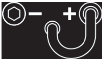
Figure B.4 – Entraînement de fil connecté en polarité positive
