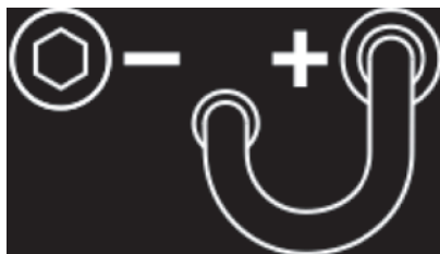
Figura B.4 Sistema de impulsión de alambre conectado para polaridad positiva
